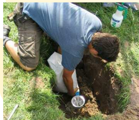
Figuur 4. Het onder de ploegzool afgewerkte putje
